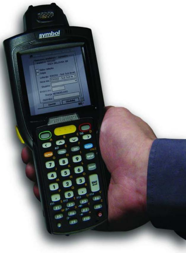
Robustni ročni računalnik z integriranim čitalnikom črtnih kod
